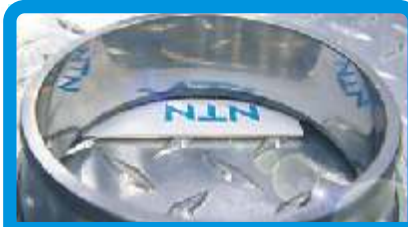
CORROSION LUISANTE PAR USURE DE CONTACT
