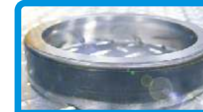
CORROSION PAR USURE DE CONTACT
